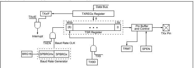
FIGURE 21-4: ASYNCHRONOUS TRANSMISSION
