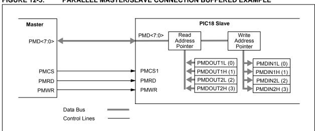
FIGURE 12-5: PARALLEL MASTER/SLAVE CONNECTION BUFFERED EXAMPLE
