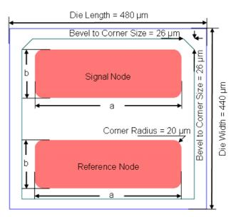
Figure 2. Sawn Die Diagram
