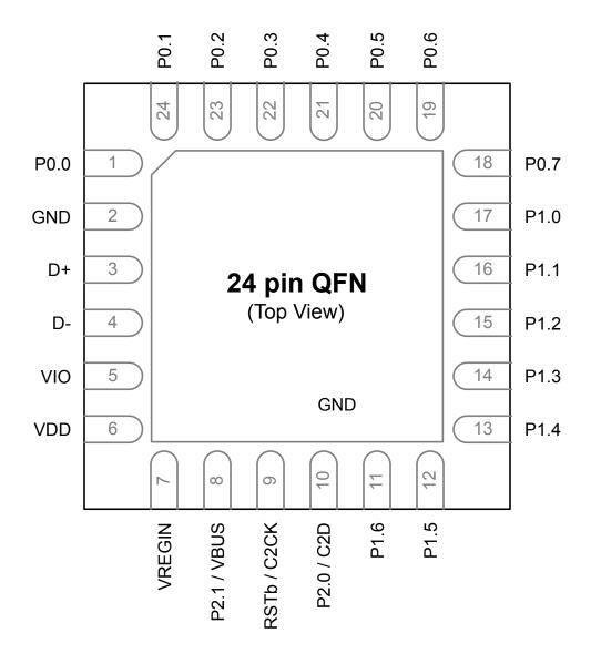
Figure 6.2. EFM8UB3x-QFN24 Pinout
