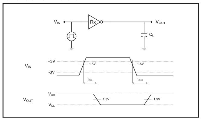
FIGURE 10. RS-232 DRIVER PROPAGATION DELAY
