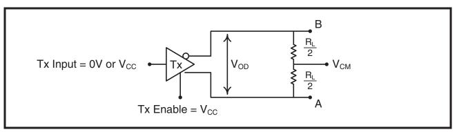
FIGURE 7. RS-485/422 DIFFERENTIAL DRIVER OUTPUT VOLTAGE OVER COMMON MODE
